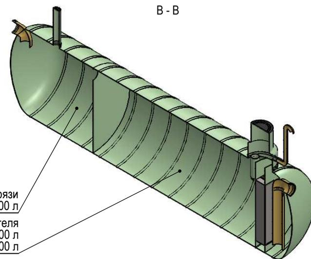
Камера для улавливания песка и грязи
